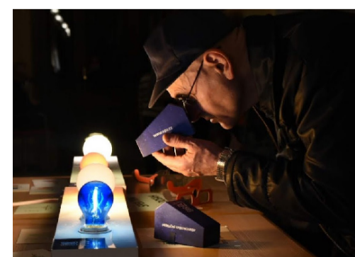
Správný úhel spektroskopu vůči zdroji
