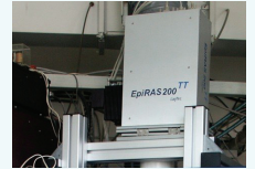
MOVPE aparatura Aixtron 200 vybavená in-situ optickou technikou RAS firmy LayTec v oddělení polovodičů Fyzikálního ústavu
