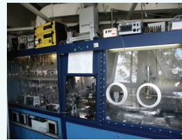
MOVPE aparatura Aixtron 200 vybavená in-situ optickou technikou RAS firmy LayTec v oddělení polovodičů Fyzikálního ústavu
